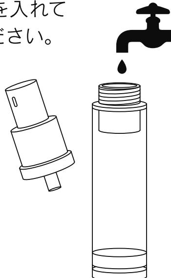
エアレス容器のため、ポンプを押すとボトル内の底にあるピストンが上昇します。
